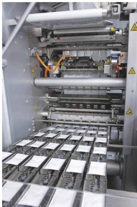
Mit einer Leistung von bis zu 125 Takten pro Minute und Bahn verlassen bis zu 1000 Flachbeutel die Maschine bei 100%iger Kontrolle
